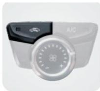
El botón de circulación interna está ubicado al interior del control circular de velocidad y la circulación interna del aire en el vehículo se usa para evitar que el aire ya "acondicionado" del automóvil escape o que el polvo y el humo del exterior ingresen al vehículo, y también para enfriar o calentar rápidamente el área de pasajeros, en este modo la circulación de aire interna es absorbida desde el compartimento de pasajeros presionando el botón del modo de circulación interno.
