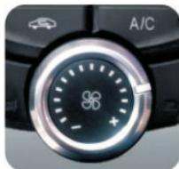
Gire la perilla de control de ventilador para controlar la velocidad y el flujo de aire del sistema. Gire la perilla a la derecha para aumentar la velocidad de aire, gírela a la izquierda para reducirlo. Usted puede ajustar el volumen de aire de acuerdo con su necesidad. Cuando la escala blanca del círculo externo se dirige hacia la escala al lado más izquierdo (al lado de "-"), será la posición de apagado.
