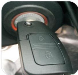
Antes de operar el motor de arranque por la segunda vez, la llave de ignición debe volver a ACC ó LOCK.
