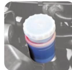
El líquido de dirección hidráulica se trata de líquido de dirección hidráulica de multi-función ATF.
