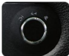
Gire el interruptor de accionamiento de cuatro ruedas a 4H ó 4L para encender el accionamiento de cuatro ruedas y se iluminarán el indicador de accionamiento de cuatro ruedas sobre el panel de instrumentos, si existe un fallo, se parpadeará el indicador.
