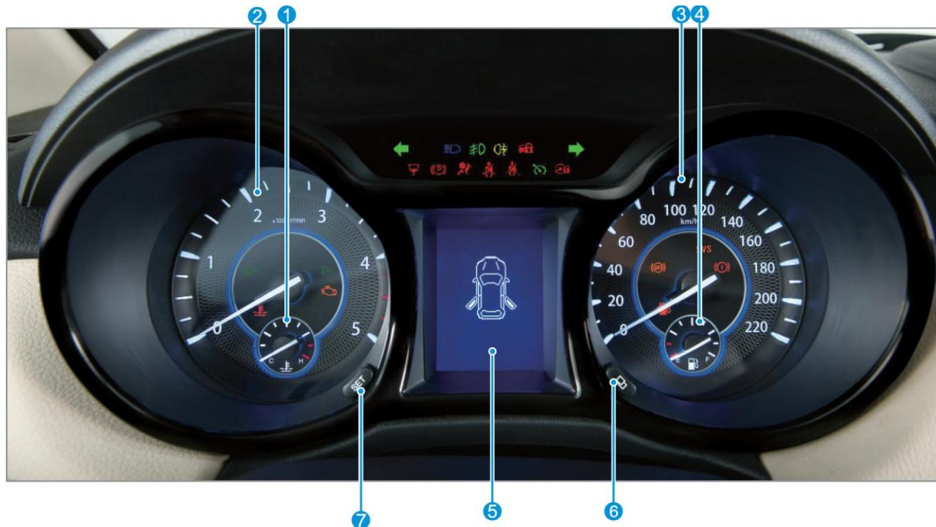
① **Medidor de temperatura del refrigerante del motor**
