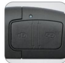
Con la llave de ignición no insertada, pulse las teclas “LOCK” y “UNLOCK” para ejecutar la función de búsqueda, en este momento, la luz de dirección parpadea por 15s, y la bocina sonará por 5s. Una vez completada la función, el anfitrión recuperará el estado antes de la función.
