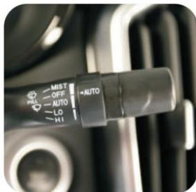
Mueva la manija de limpiaparabrisas del punto intermitente hacia atrás por 9° para realizar la función de bajar la velocidad, el motor del limpiaparabrisas delantero acciona continuamente a velocidad baja hasta que la manija de limpiaparabrisas se coloque en una posición de velocidad mas baja y continuamente mas baja, se regresa al final de todas las posiciones
