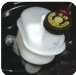
Si compruebe que este sistema fuga, debe pedir al distribuidor BAIC para revisarlo tan pronto como sea posible. Antes de aflojar la cubierta del tanque de aceite, limpie la cubierta de la boquilla y la parte superior del engrasador con el paño seco. Para añadir el líquido de freno, se debe asegurar la limpieza absoluta.
