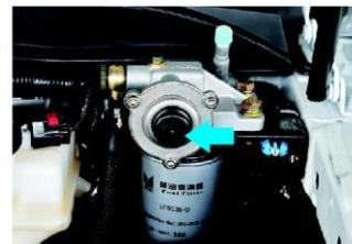
2. Afloje el perno de purga de aire sobre el separador de aceite y agua (no retire el perno, sólo necesita que se pueda purgar el aire.).
