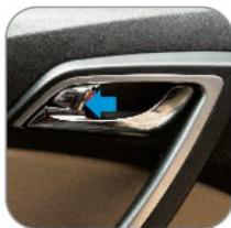
de forma individual. Cuando se bloquea y desbloquea con el pulsador de bloqueo mecánico, debe existir un intervalo por lo menos de 0,6 Seg. entre las acciones de bloqueo o desbloqueo de cada paso, le recomendamos un intervalo de 1S. En estado de corte de energía o el estado de falla del control central, debe bloquear la puerta una por otra de la forma mecánica, el método es como lo sigue:
