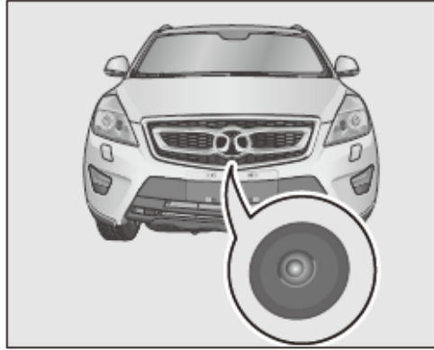
La cámara frontal está montada por debajo de la parte delantera del vehículo estándar.
