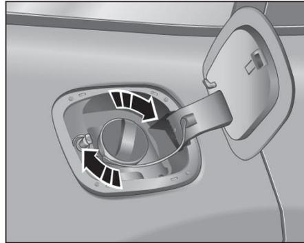
Al llenar, afloje lentamente el tapón de llenado en sentido contrario a las agujas del reloj, detenga el tapón de llenado en el llenador para liberar la presión interna antes de desenroscarlo por completo, luego retire el tapón de llenado y colóquelo en el clip.
