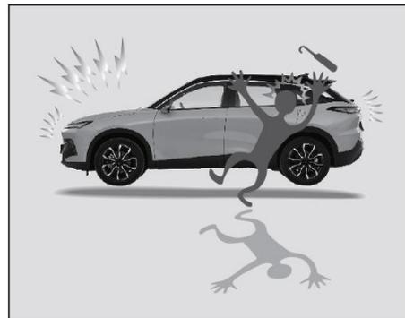
Una vez que el vehículo se bloquea con la llave inteligente, todo el vehículo entra en estado fortificado y todas las puertas, las tapas de la sala de máquinas y las tapas del maletero están en estado monitoreado. Si se descubre que unas puertas, las tapas del maletero o las tapas de la sala de máquinas se han abierto ilegalmente, por ejemplo, si alguien abre la puerta a la fuerza, se activará la alarma.
