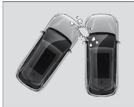
Cuando ocurre una colisión oblicua, la energía del impacto recibida por el sistema de bolsas de aire puede no ser suficiente para activar el despliegue de la bolsa de aire delantera. En este momento, es posible que la bolsa de aire delantera no se despliegue y que las bolsas de aire laterales y la bolsa de aire lateral de cortina no funcionen.
