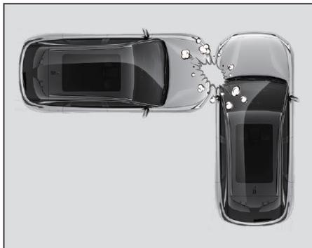
Cuando el lado exterior del compartimento de pasajeros recibe un impacto, la carrocería del automóvil recibe un impacto leve y la bolsa de aire delantera, las bolsas de aire laterales y la bolsa de aire lateral de cortina no funcionan.
