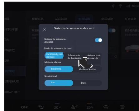
El conductor puede activar/desactivar la función de aviso de desvío de carretera a través de la pantalla de control central y seleccionar su modo de alarma y sensibilidad de alarma. Cuando el sistema está encendido, el indicador de aviso de desvío de carretera
