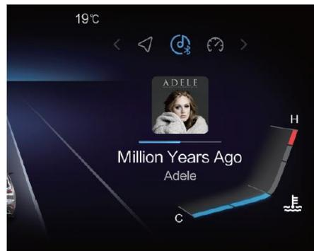
La interfaz multimedia incluye funciones de música y radio, que pueden cambiar la cubierta en función de música, nombre de la canción, información del cantante, la información de la portada y la frecuencia en la función de radio desplazándose hacia arriba y hacia abajo la rueda.
