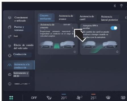
A través de la pantalla de control central, las funciones de asistencia de cruceo inteligente (incluidas las funciones de cruceo adaptativo) se pueden activar/desactivar, y se puede seleccionar el aviso de salida del vehículo anterior y el tono de aviso de objetivo.
