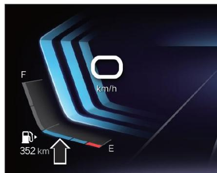
El medidor de combustible muestra la cantidad de combustible que queda en el tanque de combustible y la endurance kilometraje.
