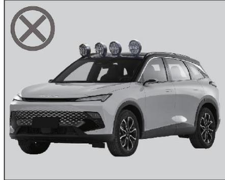
Después de instalar aparatos eléctricos de alta potencia que no sean de potencia nominal, el mazo de cables se calentará y cortocircuitará debido a la carga excesiva, lo que puede provocar un incendio.
