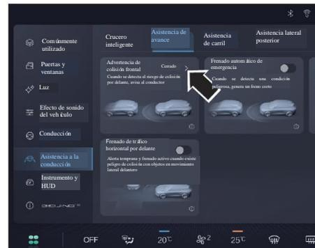
El conductor puede activar/desactivar la función de advertencia de colisión frontal y la sensibilidad de la advertencia de colisión frontal en la pantalla de control central.
