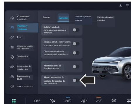
La función de cierre automático de alta velocidad del techo se puede abrir/cerrar a través de la pantalla de control central. Cuando la velocidad del vehículo es superior a 120 km/h por primera vez después de activar la función, el techo se cerrará automáticamente. En este momento, el techo se puede abrir de nuevo moviendo el interruptor del techo hacia atrás.
