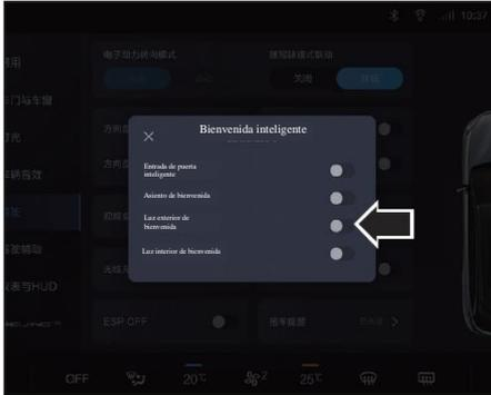
Las luces exteriores de bienvenida del vehículo se pueden encender/apagar a través de la pantalla de control central. Después de abrirlo, lleve la llave inteligente al área de detección del vehículo y la luz se encenderá.
