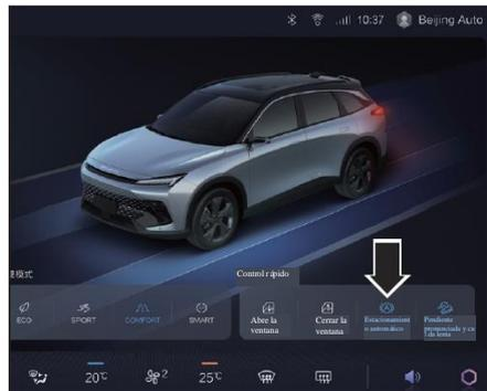
La función de aparcamiento automático
