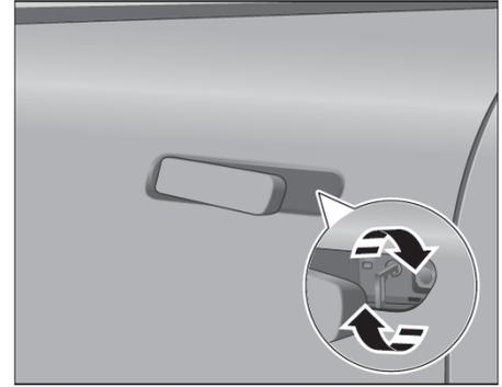
5. El cilindro de la puerta se desbloquea girando en el sentido contrario a las agujas del reloj, y se desbloquea girando en el sentido de las agujas del reloj.
