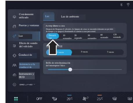
La función de acompañarme a casa puede proporcionar al conductor un servicio de iluminación diferido, y la pantalla central permite seleccionar el tiempo de retardo para la activación/desactivación de la función de acompañarme a casa.
