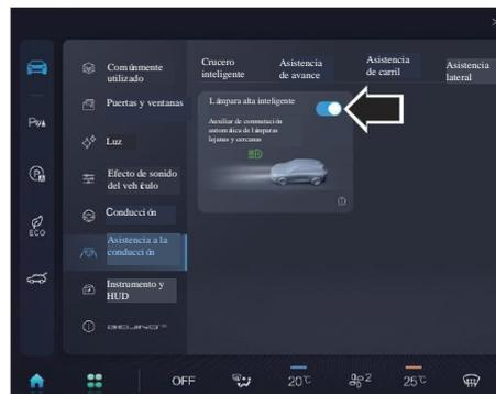
La función de indicador alta inteligente se puede activar/desactivar a través de la pantalla de control central.
