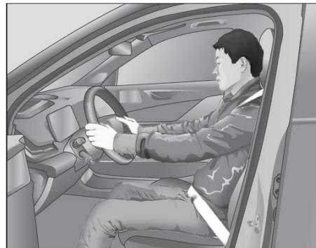
Antes de usar el cinturón de seguridad, ajuste la parte delantera y trasera del asiento, la altura y la inclinación del respaldo a la posición adecuada.
