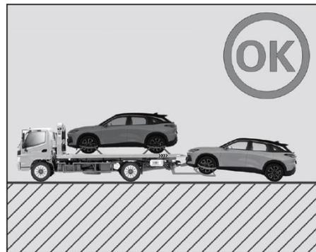
Suelte el freno de estacionamiento electr ónico del veh ículo defectuoso, levante y asegure las ruedas delanteras.
