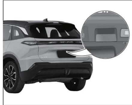
Cuando se haya desbloqueado todo el vehículo o tenga una llave inteligente, presione el botón de apertura en la tapa del maletero para abrir automáticamente la tapa del maletero.
