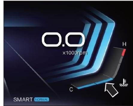
Este medidor indica la temperatura del refrigerante del motor. Durante la conducción normal, la barra indicadora azul debe indicar cerca de la posición media.
