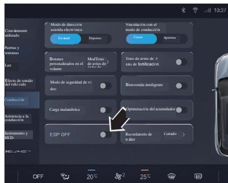
La función APAGADO de ESP se puede activar/desactivar a través de la pantalla de control central. Cuando la función APAGADO de ESP está activada, el indicador APAGADO de ESP
