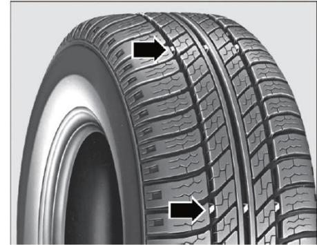
Hay marcas de desgaste en los neumáticos originales, que se distribuyen en la circunferencia de los neumáticos en la parte inferior del dibujo de la banda de rodadura. Si la banda de rodadura está desgastada hasta la marca de desgaste, se debe reemplazar el neumático en este momento.
