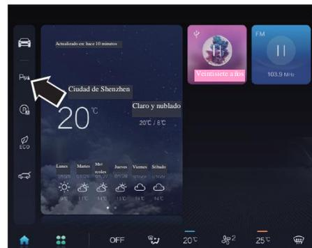
Cuando el botón de inicio/parada está en el modo "ENCENDIDO", el sistema de radar de aparcamiento se activa de manera predeterminada y el indicador del interruptor del sistema de radar de aparcamiento se enciende. El rango de velocidad de la función de radar de aparcamiento es de 0 ~ 15 km/h.
