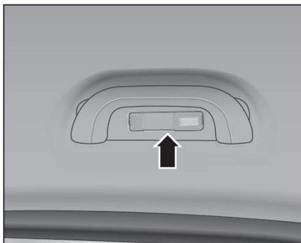
Presione el panel de la pantalla y la iluminación trasera se enciende. Vuelva a presionar el panel de la pantalla y la iluminación trasera se apagará.
