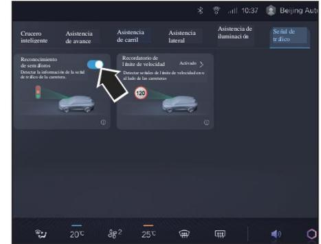
El conductor pueden activar/desactivar la función de reconocimiento de semáforos a través de la pantalla de control central.
