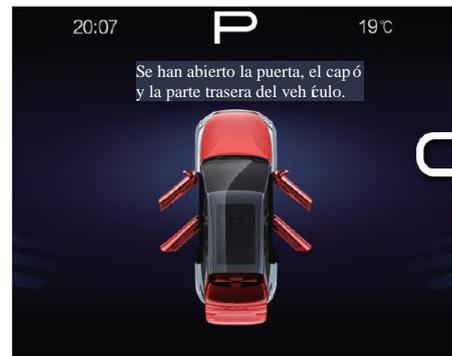
Si se deja abierta una puerta, una capina o la cubierta del maletero, la pantalla del computador mostrará en rojo la puerta, la capina o la cubierta del maletero correspondiente sin cerrar.
