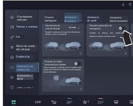
El conductor puede activar/desactivar la función de frenado automático de emergencia en la pantalla de control central.
