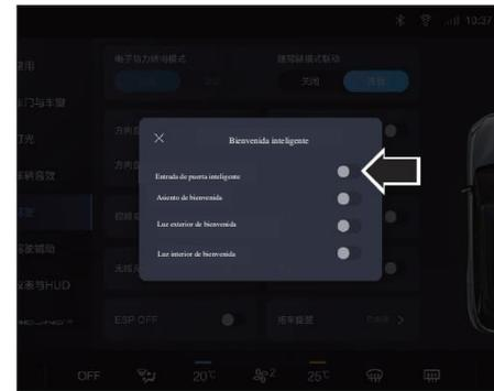
La función de entrada inteligente de la puerta se puede abrir/cerrar a través de la pantalla de control central. Después de abrir, cuando el vehículo esté en un estado fortificado, lleve la llave inteligente al área de aproximadamente 1,5 ~ 2 metros de la manija de la puerta delantera del vehículo, y la manija oculta se desplegará automáticamente \* y la cerradura de la puerta se desbloqueará
