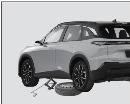
3. Gire el balancín del gato para que la ranura de la cabeza del gato quede atascada en el punto de apoyo de la carrocería del vehículo, pero no levante el vehículo;
