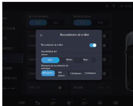
La función de recordatorio de remolque se puede encender/apagar a través del panel de control central, y se puede configurar la sensibilidad del sensor (alta, media y baja) y la distancia de recordatorio del remolque (200 m, 500 m, 1 km y 2 km).
