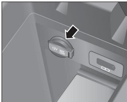
El tomacorriente de 12V en la caja de la consola central está ubicado en el frente de la caja reposabrazos central. Abra la tapa de la toma de corriente de 12V y luego use el enchufe del vehículo para obtener electricidad a través de la toma de corriente.
