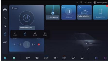
El botón de inicio/parada sin llave se encuentra en el modo "ENCENDIDO" y el modo de conducción se puede seleccionar a través de la pantalla de control central.
