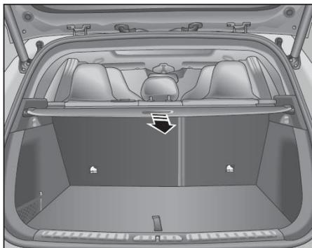
Tire de la cortina del maletero en la dirección de la flecha y fíjela en la ranura de fijación de la placa embellecedora central del montante C para cubrir los artículos del maletero.
