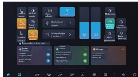
Después de ajustar la posición del asiento, en la pantalla negativa de la pantalla de control central (deslice hacia abajo desde la parte superior de la pantalla para abrir la pantalla negativa y hacia arriba para cerrarla), presione posición sentada 1, posición sentada 2 o posición sentada 3 durante mucho tiempo para recordar la posición.
