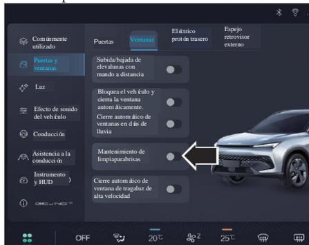
Asegúrese de activar el modo de mantenimiento cuando el limpiaparabrisas del parabrisas necesite mantenimiento. Para evitar la operación repentina del limpiaparabrisas del parabrisas, se producirán lesiones personales o daños al vehículo. Cuando encienda el limpiaparabrisas para el mantenimiento, el limpiaparabrisas se desplazará automáticamente a la posición de mantenimiento.
