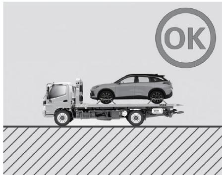
El mejor m étodo de remolque es cargar y fijar el veh ículo defectuoso al veh ículo de rescate, que debe preferirse cuando el veh ículo necesita ser remolcado en caso de accidente.
