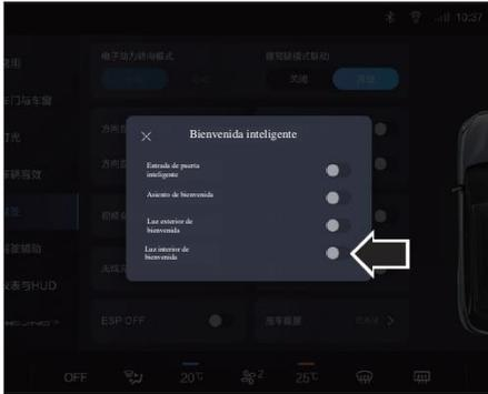
La función de luz de bienvenida en el vehículo se puede encender/apagar a través de la pantalla de control central.
