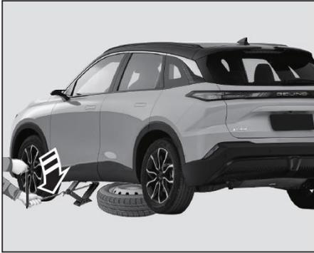
7. Gire el conjunto del gato en el sentido de las agujas del reloj para levantar el vehículo hasta que las ruedas defectuosas se separen del suelo;
