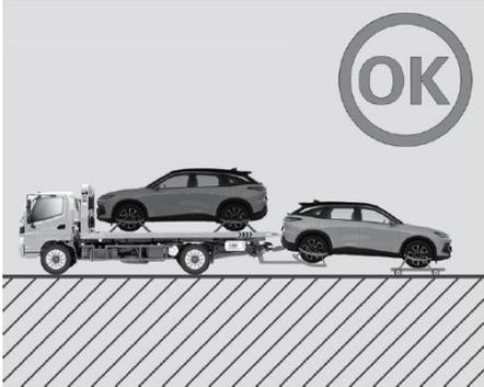
Suelte el freno de estacionamiento electrónico del vehículo defectuoso, levante y asegure las ruedas traseras y asegure las ruedas delanteras al scooter.
