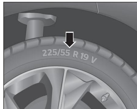
Consulte la carta de neumáticos del vehículo para saber el modelo y tamaño de neumático que necesita. Se deben usar llantas con la misma marca, especificación, tamaño, patrón y grado antiguo y nuevo en el mismo eje.
