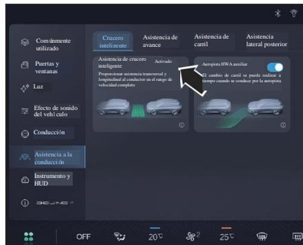
A través de la pantalla de control central, la función de asistencia de cruceo inteligente se puede activar/desactivar, y se puede seleccionar el aviso de salida del vehículo anterior y el sonido del aviso de objetivo.
