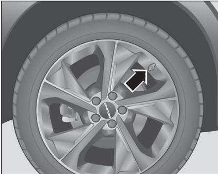
1. Gire la tapa de la válvula en sentido contrario a las agujas del reloj desde la válvula del neumático y revise si la válvula tiene fugas de aire con solución de jabón;
