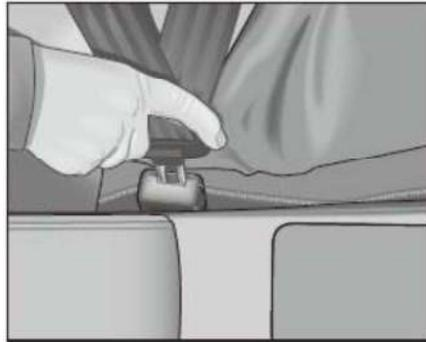
Ajustar correctamente el asiento delantero y su cabecera. Tire del cinturón de seguridad desde el retractor, hasta que inserte el cierre del cinturón en la hebilla y apriete el cinturón de seguridad. Cuando el pestillo está bloqueado dentro de la hebilla, se escuchará un sonido de clic.
