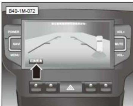
Como indica la flecha, presione "Cambiar ángulo de visión" para cambiar entre ciclos entre "Vista normal", "Vista superior" y "Vista de pájaro". El ángulo de visualización predeterminado se puede ajustar en la pantalla de DVD y, para más detalles, consulte la sección "Pantalla de visualización de DVD".
