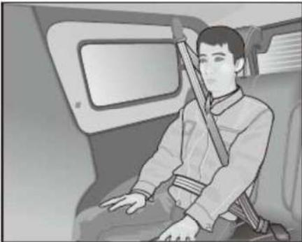
Ajuste el reposa-cabezas del asiento trasero si es necesario, Siéntese erguido en el asiento trasero y que la espalda se ajuste al respaldo del asiento lo más posible. Tire el cinturón de seguridad fuera desde el tensor en la parte superior del lado más cercano, inserte el cierre del cinturón en la hebilla y ajuste el cinturón de seguridad. Cuando el pestillo está bloqueado dentro de la hebilla, se escuchará un sonido de clic.
