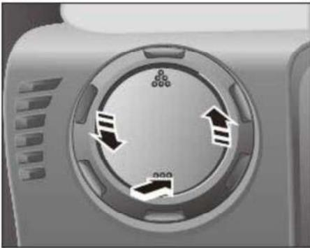
El respiradero del lado del conductor se ajusta de la misma manera que el respiradero central.
