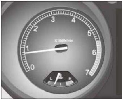
El principio de la zona roja en el indicador del tacómetro indica la velocidad máxima permisible del motor. Sólo después de que el motor se ha asentado normalmente y alcanzado la temperatura de operación normal podrá funcionar a esta velocidad.
