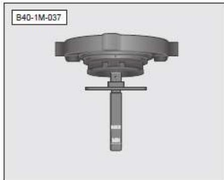
Para evitar que el polvo entre en el tanque de almacenamiento, limpie la tapa de llenado y desatornille la tapa de llenado como se muestra en la imagen antes de verificar el nivel de líquido:
