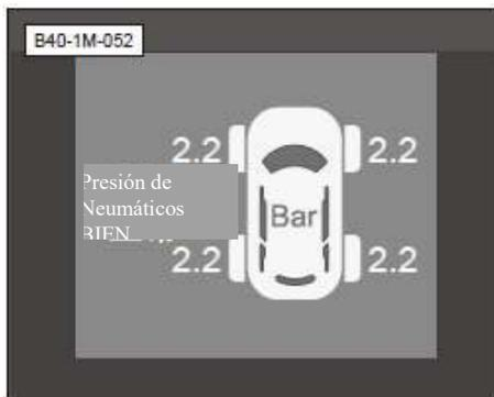
Después de que el vehículo alcanza una velocidad de 30km/h, la interfaz se selecciona con interruptor de control en el centro de información, en el cual el conductor puede saber la información acerca de la actual presión de los neumáticos del vehículo.
