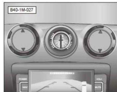
Para ajustar el volumen de flujo de aire de cada salida, es necesario empujar cualquier lugar que está marcado con la de flecha de la salida, abrir la salida y ajustar la dirección o el volumen del flujo de aire. Si continúa empujando la pieza de plástico o empujándola en la dirección opuesta, se cerrará la salida.
