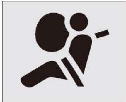
La luz de advertencia de fallo de la bolsa de aire en panel de instrumentos le alertará a los fallos con las bolsas de aire y los pretensores de cinturón de seguridad.
