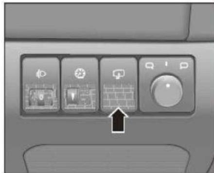
Como se muestra en la figura, el botón de plegado eléctrico del espejo retrovisor exterior se encuentra en el cuadro de interruptores del tablero en el lado del conductor.
