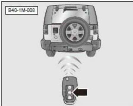
En el modo de antirrobo, pulse la tecla de puerta trasera para desbloquear la puerta trasera, el portón se cerrará otra vez después de que está abierto, y después de algún tiempo, será automáticamente bloqueado. Si la puerta no se abre después de algún tiempo después de presionar la llave de la puerta trasera, se bloqueará automáticamente y luego inmediatamente entrará en el modo de antirrobo.
