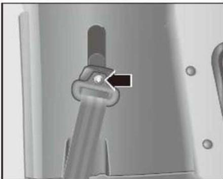
Desenrosque los pernos de retención del ajustador de altura del cinturón de seguridad y, a continuación, retire el regulador de altura del cinturón de seguridad (la imagen muestra el lado derecho del vehículo como ejemplo).
