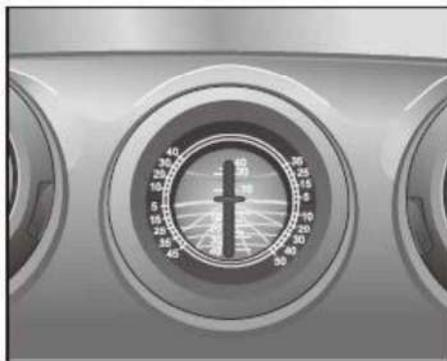
Desde el gradiómetro, puede leer el ángulo horizontal de su vehículo en el sentido longitudinal y vertical, lo que le permite conocer la posición actual de su vehículo con referencia en el plano horizontal.
