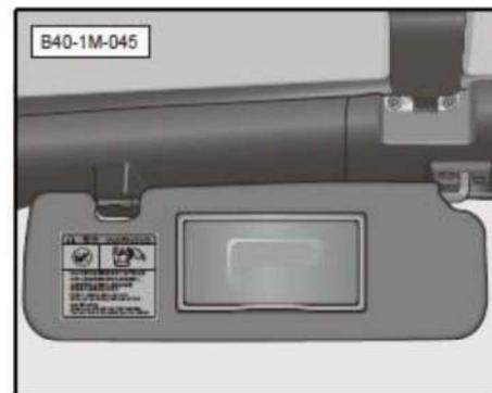
Las viseras en el lado del conductor y el lado del pasajero delantero se pueden sacar de sus respectivos soportes. Luego, en la dirección de -la fecha - gire la puerta del vehículo y bloquee la luz del sol de la puerta del vehículo y las ventanas. (La imagen toma el lado del pasajero delantero como un ejemplo).
