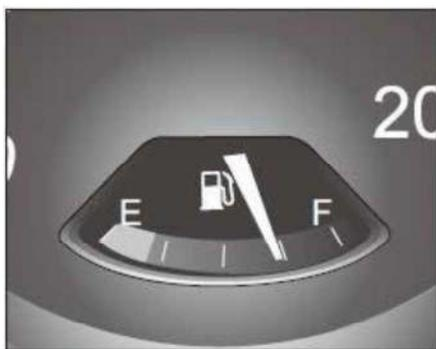
El indicador de combustible está situado bajo el odómetro. Cuando se gira la llave de encendido a la posición "ON", el indicador de combustible mostrará el volumen de combustible restante en el tanque de combustible. De "E" a "F", indica el cambio en la cantidad de combustible en el tanque de combustible, de vacío a lleno. Cuando la llave no está en la posición "ON", el puntero volverá a la posición E, y no se muestra el volumen actual de combustible restante.
