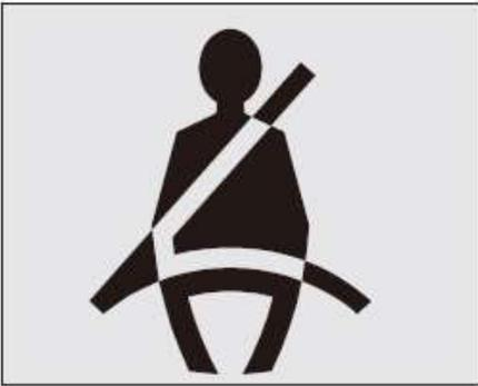
Si el interruptor de ignición se enciende pero el conductor no abrocha el cinturón de seguridad, se encenderá la luz indicadora de cinturón de seguridad en la pantalla del panel de instrumentos. Si el conductor no abrocha el cinturón de seguridad y la velocidad del vehículo supera los 25 kilómetros por hora, o cuando el vehículo se mueve hacia adelante una distancia de 500m o más de 60 segundos a una velocidad de 25km, luz de advertencia se encenderá, acompañando una alarma audible.
