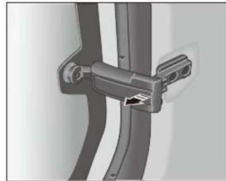
1. En la dirección de la -Flecha - como se muestra en la figura, tire de la manilla de bloqueo de la ventana del vehículo para cancelar el bloqueo de la posición.
