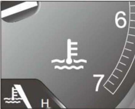
La luz de advertencia de refrigerante de motor (rojo) se encuentra en el interior de tacómetro de motor. Cuando el refrigerante del motor está demasiado caliente, se encenderá esta luz de advertencia. En este momento, se debe estacionar su vehículo en un lugar apropiado como rápidamente como sea posible con seguridad, apague el motor, compruebe el nivel de refrigerante y vea si hay alguna fuga de la tubería de refrigerante.
