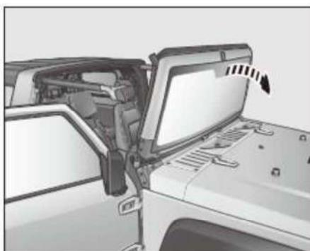
9. En la dirección de la flecha como se muestra en la figura, lentamente puso el parabrisas frontal hacia abajo y fijar firmemente el parabrisas delantero para el cofre del motor.
