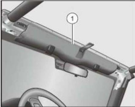
Retire el panel de corte de la viga superior -1- del parabrisas como se muestra en la figura.
