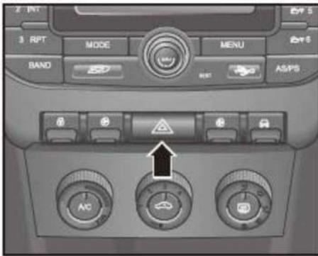
Como se muestra en la figura, el interruptor de luz de advertencia se encuentra dentro del panel de control central.
