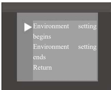
1. Después de entrar en la interfaz de calibración de la brújula, se posicionará el cursor (triángulo) en "Environment Setting". Presione el interruptor de control del centro de información y el cursor empezará a parpadear y comenzará la calibración.
