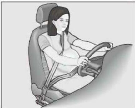
Si es una mujer embarazada, la mejor manera de protegerse a usted y su feto es que use siempre el cinturón de seguridad correctamente cuando se conduce o está sentada en el asiento del copiloto y haciendo que la parte de la cintura del cinturón de seguridad pase por encima de sus caderas tan bajas como sea posible.
