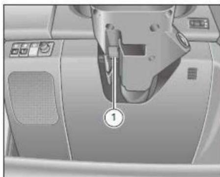
3. a continuación, empuje la palanca de fijación -1- hacia arriba y asegúrelo.
