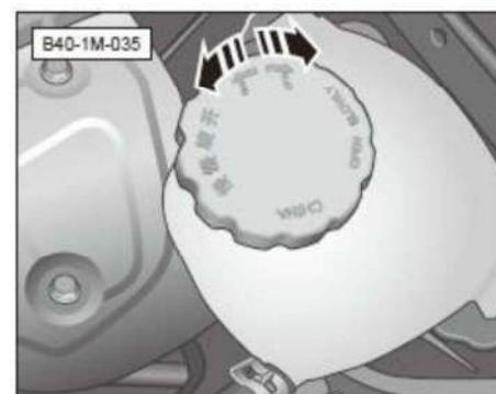
El motor no debe estar en marcha. Para evitar quemarse, envuelva la cubierta del depósito de recuperación de refrigerante con un pedazo de tela grande y gruesa, y gire en sentido contrario a las agujas del reloj como indica la Flecha.
