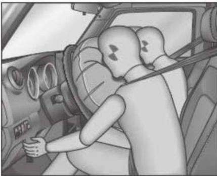
En caso de colisión, la unidad de control de bolsas de aire supervisará la desaceleración o aceleración causada por la colisión y determinar si deben desplegarse las bolsas de aire frontales.
