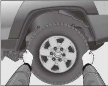
Alinee el orificio de instalación de la rueda de repuesto con el orificio de instalación en el disco de freno.
