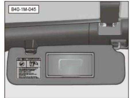
Hay una etiqueta de advertencia pegada en la visera del vehículo del lado del acompañante, para recordarle a usted y su acompañante de los peligros causados por las bolsas de aire frontales. Asegúrese de leer y seguir las instrucciones en esta etiqueta.
