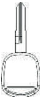
Introduzca la llave en el mecanismo en el orificio de la llave de la puerta (conductor o acompañante), gírela en el sentido de las agujas del reloj y, a continuación, gírela en sentido contrario. Al abrir la puerta, gírela en el sentido contrario a las agujas del reloj y, a continuación, gírela en el sentido de las agujas del reloj, y se abrirá la puerta correspondiente. Abrir/cerrar puertas con llave mecánica (dentro del vehículo)
