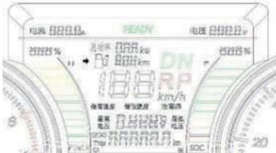
El contenido de la pantalla incluye: indicador “READY” (se muestra cuando el vehículo está en modo de conducción), kilometraje total, subtotal de kilometraje, velocidad del motor, temperatura del motor, velocidad del vehículo, posición de la velocidad, voltaje total, corriente, potencia total y duración de la batería
