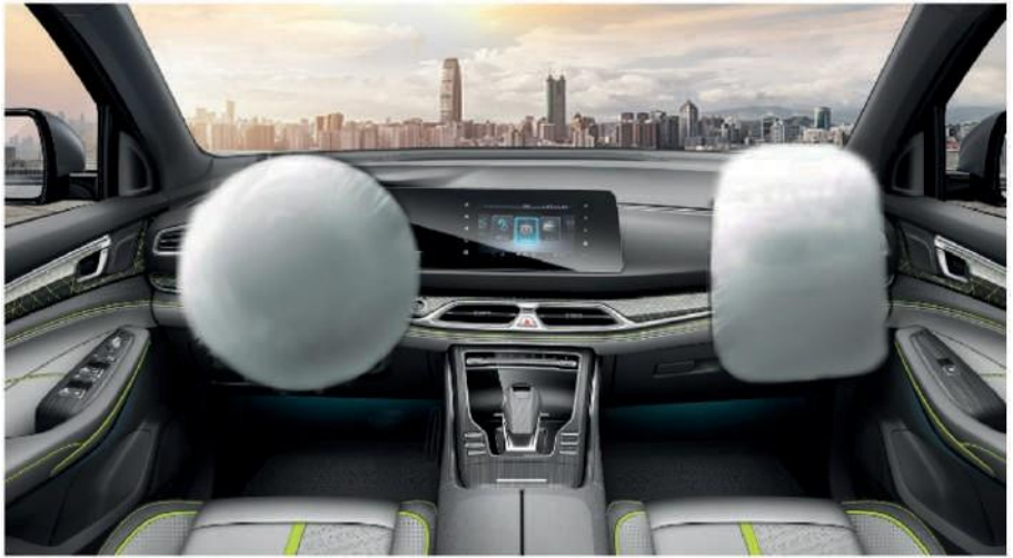
Ilustración del despliegue de las bolsas de aire principal y del pasajero
