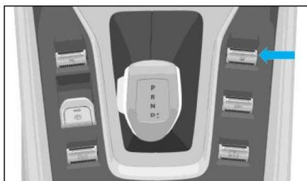
Si se pulsa el interruptor de desactivación del ESC durante menos de 10 s, se enciende la luz indicadora, que indica que el ESC está desactivado y que las funciones TCS y ESC se desactivarán. Vuelva a pulsar el interruptor ESC off, el indicador se apaga. Esto indica que el ESC está activado
