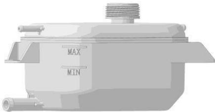
Compruebe visualmente el nivel de líquido mirando las marcas exteriores a ambos lados del conjunto del depósito. No retire el tapón de la botella de almacenamiento de agua y no añada líquido. De lo contrario, los posibles daños no estarán cubiertos por la garantía. El nivel del líquido debe estar entre las marcas MIN y MAX. Si observa un descenso significativo del nivel de líquido, póngase en contacto con su embajada MOTORNATION antes de utilizar el vehículo.
