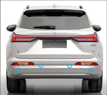
Cuando se desplaza lentamente hacia delante o hacia atrás, si detecta un objeto cerca del parachoques delantero o trasero, los sensores le avisarán. Durante la conducción, si se detecta un objeto a ambos lados del vehículo, se encenderá el testigo correspondiente en el retrovisor exterior lateral para avisarle. Las configuraciones específicas pueden variar en función del equipamiento.
