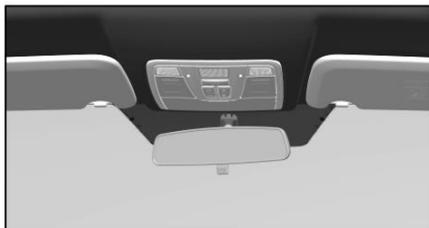
Tire de la palanca de ajuste situada debajo del retrovisor interior hacia atrás para activar el modo anti deslumbramiento; empuje la palanca de ajuste hacia adelante para desactivar el modo anti deslumbramiento.
