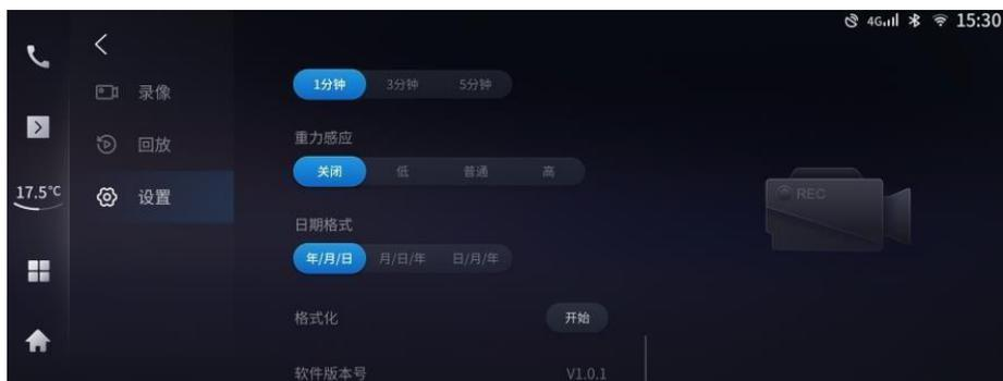
En la interfaz de pre visualización en tiempo real, toca el botón de configuración de la izquierda para acceder a la interfaz de configuración, donde podrás personalizar los ajustes de resolución, grabación en bucle, detección de gravedad, formato de fecha, formato, etc.
