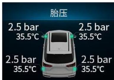
La presión y la temperatura de las llantas pueden detectarse mediante sensores de internos, y la información se transmite al panel de instrumentos a través de la computadora, mostrándose en tiempo real en la pantalla de visualización del panel de instrumentos.
