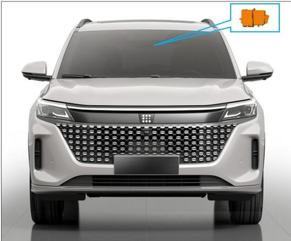
El grabador de conducción registra la información a través de la cámara de definición estándar y la guarda en una tarjeta de memoria. Las grabaciones en tiempo real pueden transmitirse a la pantalla de la unidad principal mediante un cable de datos, para poder ver las grabaciones de la grabadora de conducción en cualquier momento.
