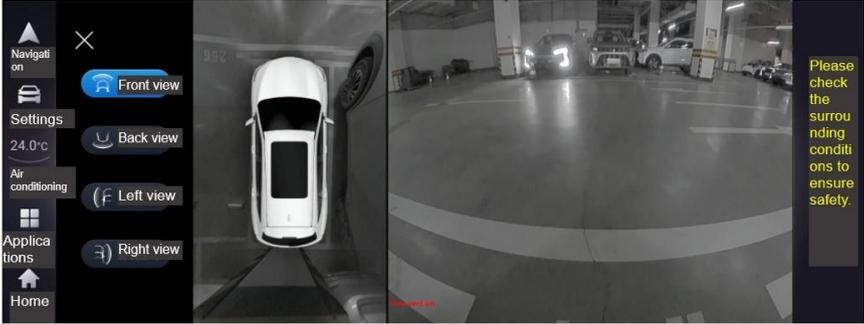
Para desactivar la pantalla panorámica, puede Presionar el interruptor panorámico situado en la tapa inferior izquierda del tablero, debajo del volante, para desactivar el modo panorámico. Tenga en cuenta que una vez que pulse el interruptor para desactivar el modo panorámico, éste permanecerá desactivado hasta que vuelva a Presionar el interruptor para volver a activarlo.
